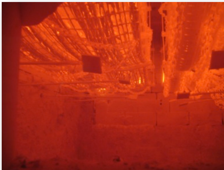
Rys. 4. Zespół kablowy BAKS-TECHNOKABEL przed badaniem funkcji wg DIN 4102-12. [fot.Technokabel]
