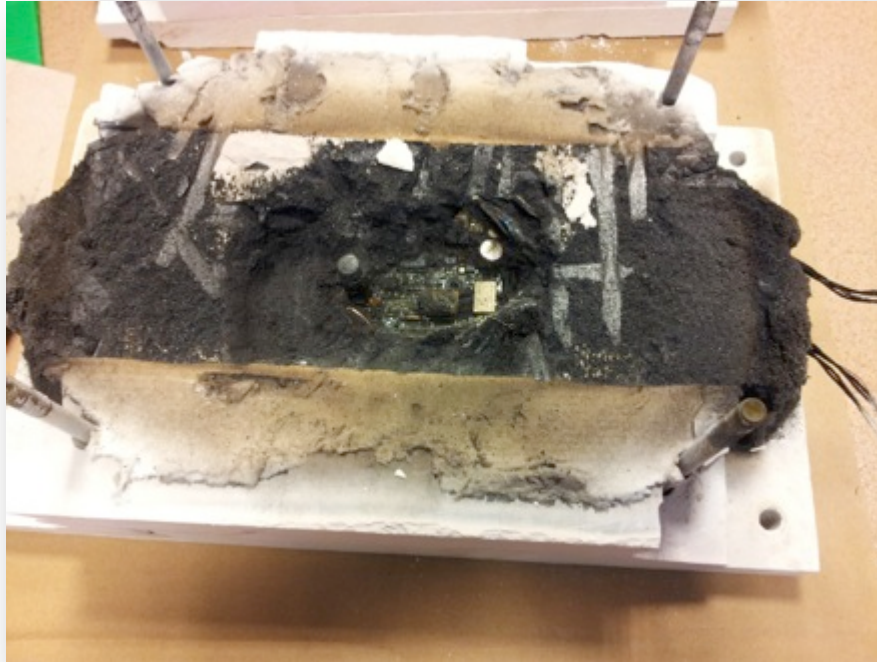
Rys. 12. Obudowa po teście 60 minut wygrzewania wg krzywej ETK
